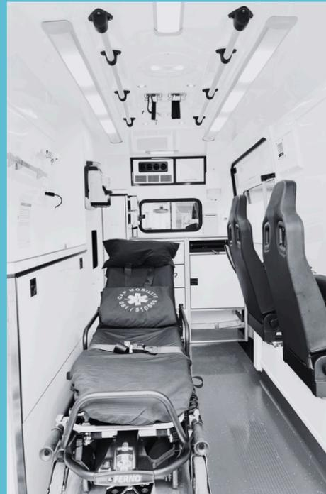
À ces fins, nous avons donc équipé ce véhicule d'une suspension intégrale sur coussins d'air (disposés individuellement sur chaque suspension) ce dispositif complété par des barres de renforcement et antiroulis favorise un confort optimal pour nos patients. Ce véhicule est également complété par un brancard ne nécessitant aucune manipulation pour le rentrer ou le sortir de l'ambulance.
